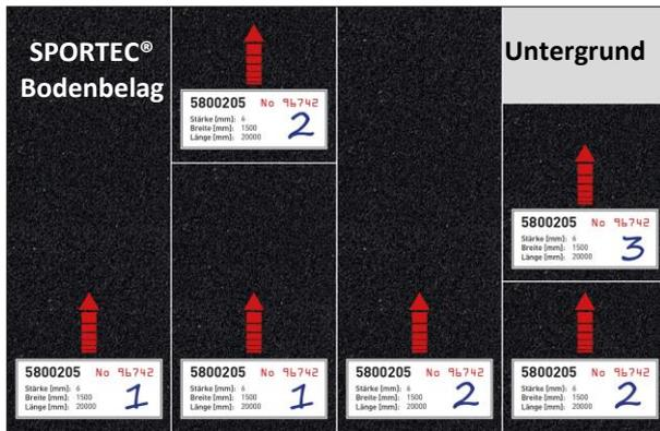
Ausrollen der fortlaufenden Bahnen in die gleiche Laufrichtung (**ACHTUNG:** Etikett ist auf der Unterseite des Belages)
